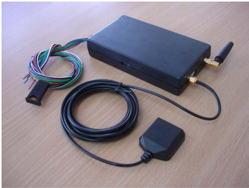
El dispositivo **UBITrack** es un equipo pensado para realizar el seguimiento satelital de flotas y vehículos.
